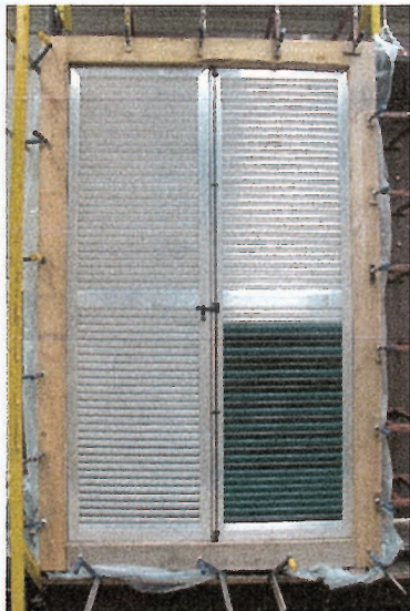
Fot.1 Próbką 557 na stanowisku badawczym. Ustawienie do obciążenia od strony zewnętrznej
